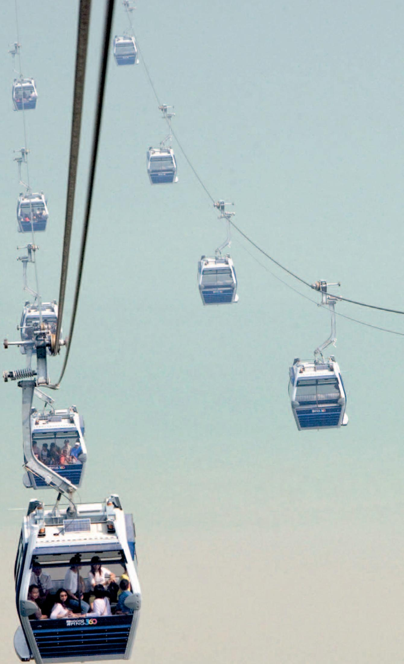
**ZWEISEILUMLAUFBAHNEN** passen sich auch widrigsten Verhältnissen an. Die getrennte Trag- und Zugfunktion der Seile ermöglicht extrem lange Spannfelder von über 2.500 m. Steiles und ausgesetztes Gelände mit extremen Höhendifferenzen wird mit wenig Aufwand überwunden. Die Natur wird dabei durch die geringe Stützenanzahl geschont. Trotz langer Spannweiten beeinträchtigt auch starker Wind den Bahnbetrieb nicht. Komfort und Förderleistung entsprechen ganz den Bedürfnissen moderner Fahrgäste.
